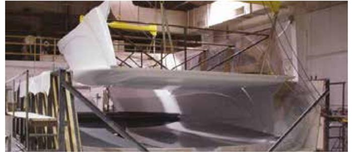
Desmoldeo de un puente alto de un yate de 80'
