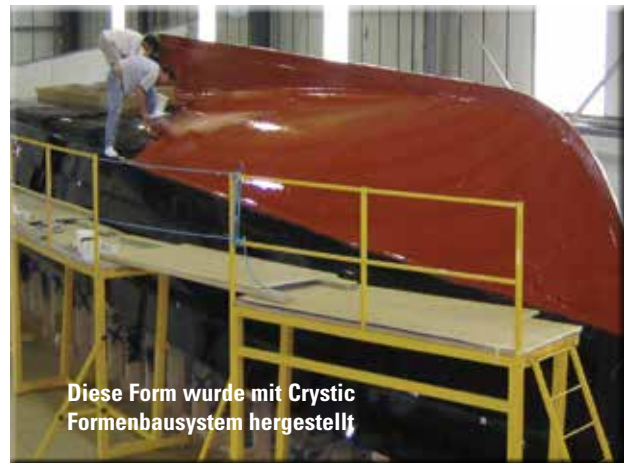
Hochglänzendes, wassermarkierungsfreies Formenteil aus einer von Hi Spec hergestellten Form unter Verwendung von Rot 5201 Crystic 14 PA Formenbau Gelcoat
