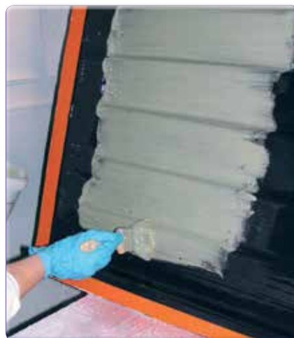
El Crystic Crestacoat 5000PA puede luego aplicarse con brocha en áreas más pequeñas.
