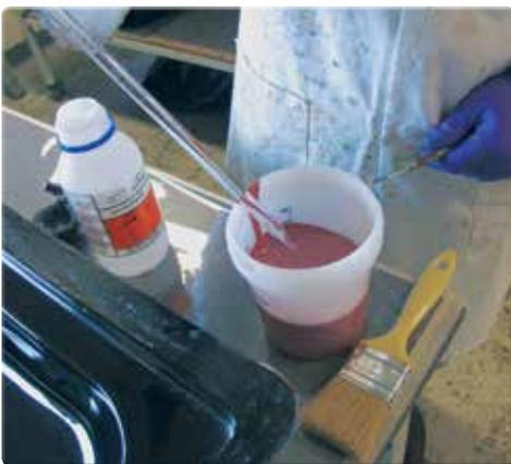
Ajoutez précisément 2 % de catalyseur au Crystic Mouldguard.
