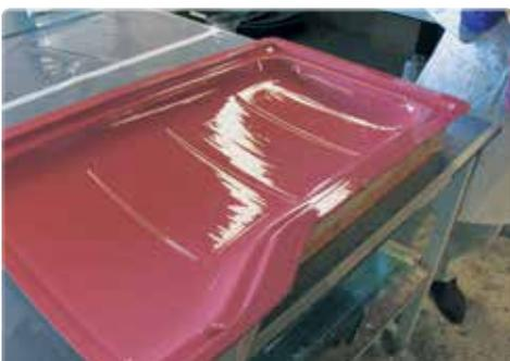
Recouvrez entièrement le moule en vous assurant qu'il n'y a aucun manque et aucun refus. Recouvrez également les plages périphériques. Laissez polymériser avant le stockage.
