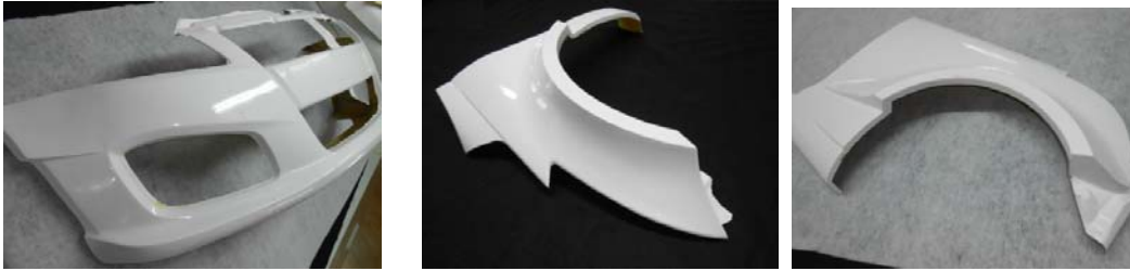
Pie de foto: Nuevas secciones de parachoques delantero y alerón rediseñadas de los coches de rally Suzuki S1600, fabricadas con revestimiento de gel blanco en spray Crystic® 97PA y aplicación de vacío de la resina acrílica Crestapol® 1250LV, reforzada con tejidos de vidrio de sillonne y aramida.
