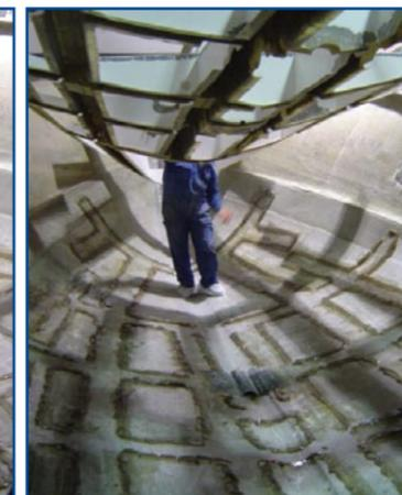
**2** Positionnez le réseau de raidisseurs sur la coque sèche afin de vous assurer que l'ajustage est bon, et indiquez les zones de fixation sur la coque.
