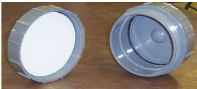
Eprouvettes circulaires utilisées pour le test de tenue à l'osmose, 12 mois à 40°C dans l'eau déionisée.
